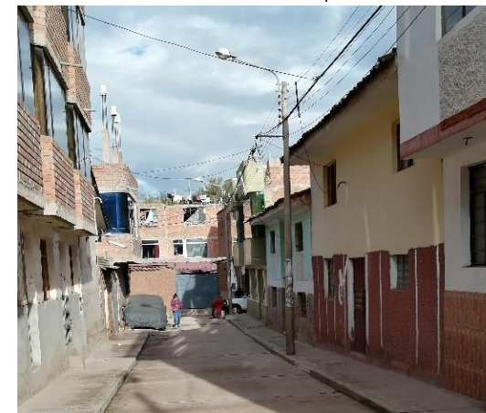
Imagen N° 40: Poste de alumbrado público instalado dentro de la acera disminuyendo y obstaculizando el tránsito peatonal
